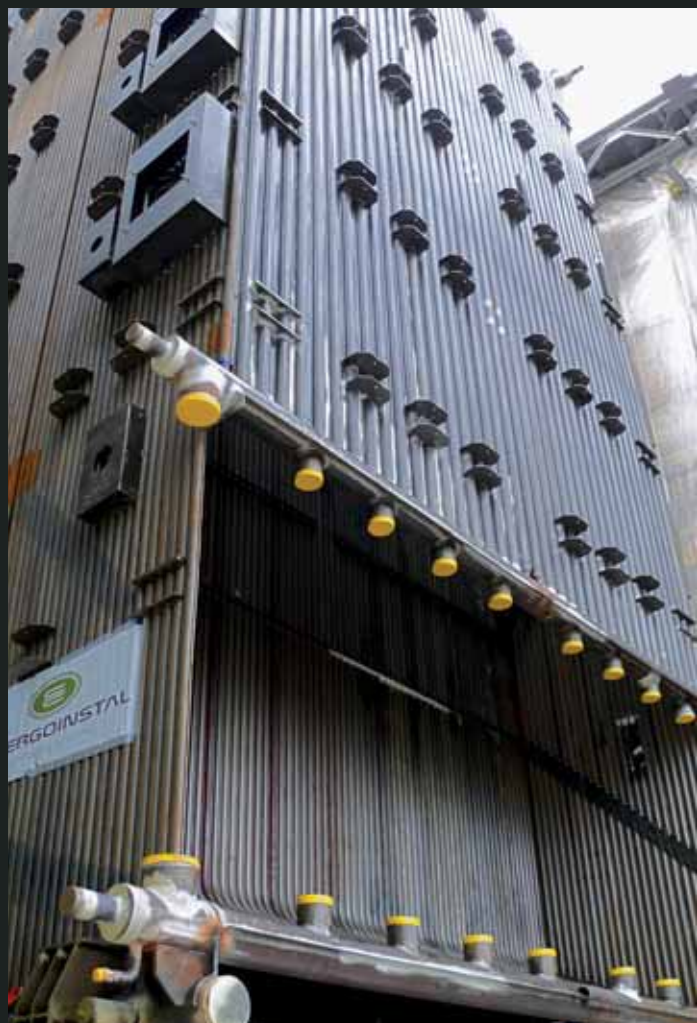
Pierwszy kocioł energetyczny wytworzony w technologii laserowej w CITL dla ECO SA.
